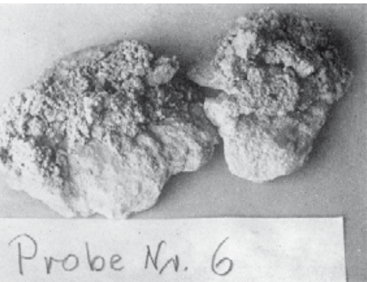
Fig. 11. Detalle de una de las pruebas realizadas por el Sr. Artur Kratz (15) mediante impregnación al vacío con silicatos y fluatos. Negativo: Artur Kratz.
