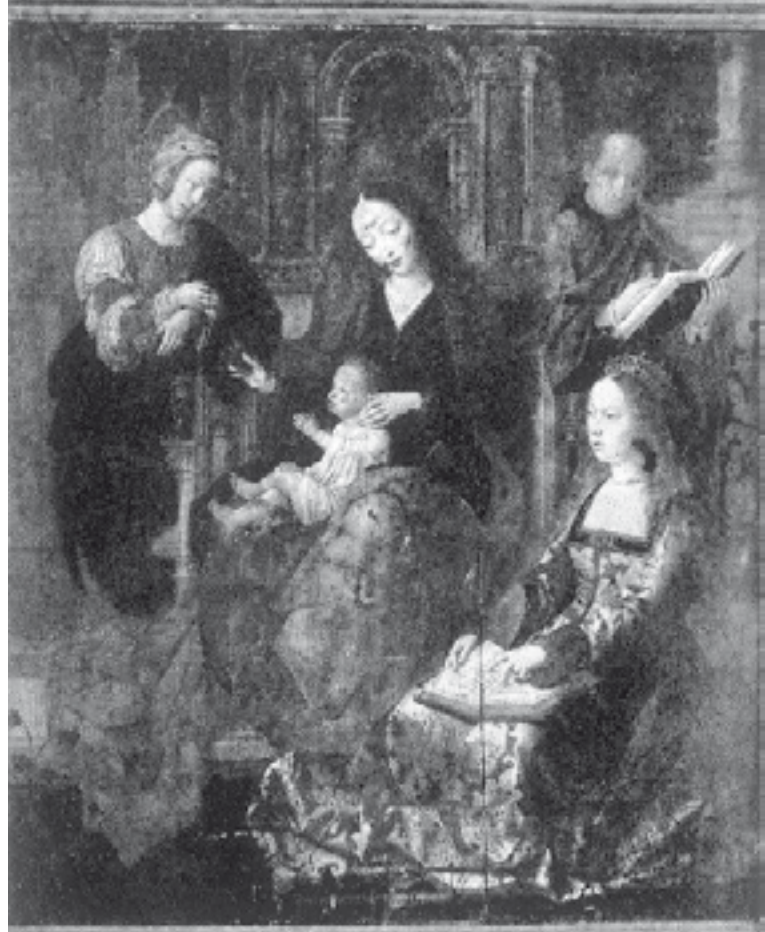
Fig.12 Fotografía de la "Virgen de la mosca" en fluorescencia U.V. Iluminación: 4 lámparas ultravioleta de 125 w. fabricación Philips. Filtro ultravioleta colocado en el objetivo de la máquina. Material sensible: Ilford. Hp. 3. Técnica operatoria: tiempo de exposición, 30 minutos; revelador, Kodak D-76; tiempo de revelado, 10 minutos.
