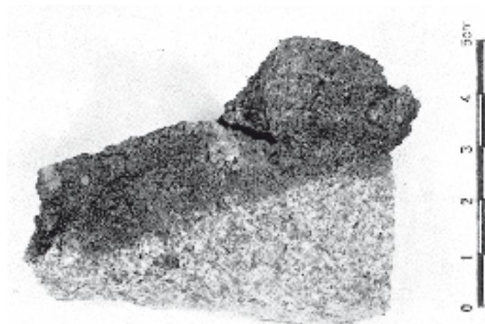
Fig. 19. Ensayo de penetrabilidad en una muestra de piedra procedente del Monasterio de Ripoll. Con disolución de poliacetato de vinilo al 2.5 por 100 en acetona-tolueno (1:4), coloreada con azul nitrosólido (de Sandoz), la penetración conseguida aplicando el producto con un pincel, sobrepasa los 2 centímetros.
