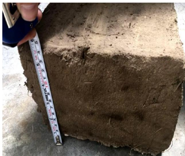
Figura 1.- Obtención de dimensiones. Fuente: Elaboración propia
