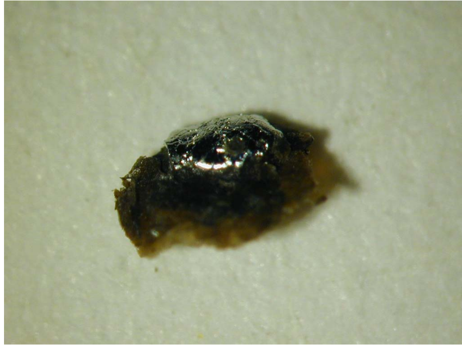
Figura 2. Imagen de detalle de un fragmento de la decoración metálica en la que pueden apreciarse la capa brillante superior, producto de una intervención de restauración, y la capa oscura inferior, correspondiente al embutido original degradado.
