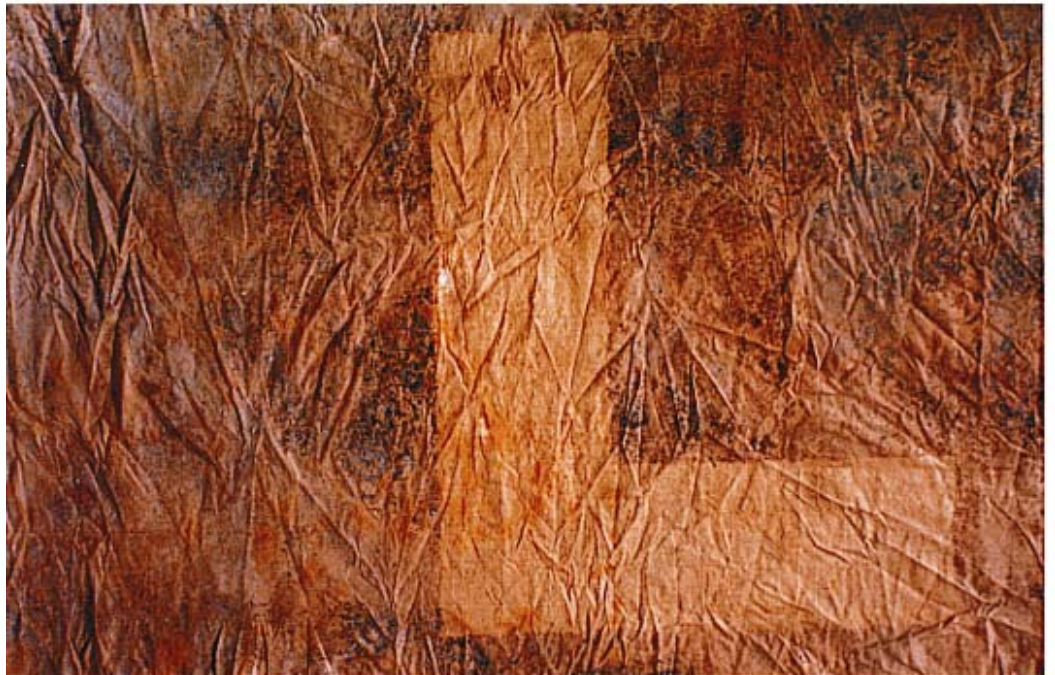
2. Fragmento de seda (siglo XIII) sometido a prueba de limpieza con láser.
