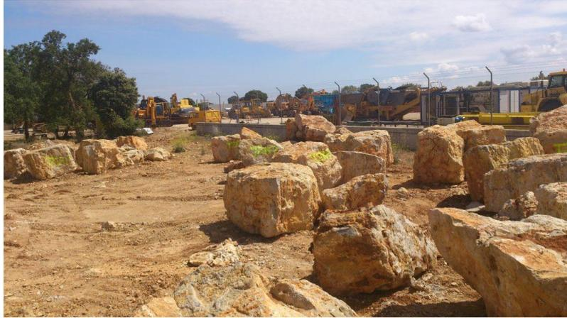
*Selección de bloques de caliza en cantera, marcando los cortes óptimos.*
