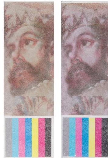
Resultado de una probeta con transferencia tramada tras 1000h. en cámara de envejecimiento acelerado
