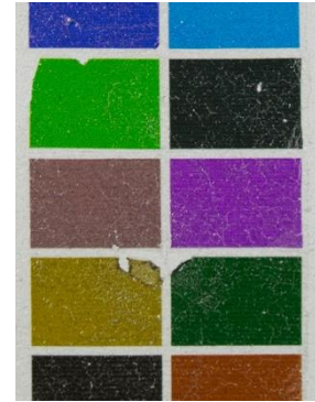
Detalle de probeta con transferencia continua
